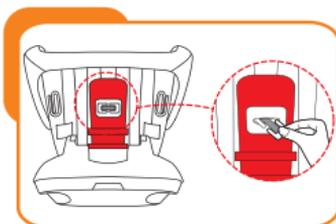
Установите детское сиденье в положение 3 и переверните его. Поверните замковую фиксирующую скобу узким концом и протяните через прорезь под нижней частью детского сиденья. Таким образом, чехол и пряжка, а также ремни безопасности могут быть сняты.
