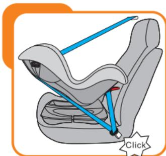
**Шаг 4:** Вставьте диагональный ремень вместе с поясным ремнем в автомобильный замок ремня безопасности, услышав "щелчок". Проверьте, чтобы пряжка ремня безопасности была правильно вставлена в замок.
