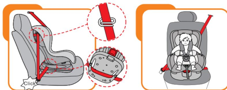
Шаг 3. Вставьте диагональный ремень вместе с поясным ремнем в автомобильный замок ремня безопасности, услышав "щелчок". Проверьте, чтобы пряжка ремня безопасности была правильно вставлена в замок.
